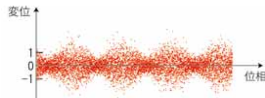
光パラメトリック増幅器で作られる「スクイズド(押しつぶされた)光」の図。半波長ごとに、波の一部が押しつぶされ絞られている(量子ゆらぎが抑圧されている)。この絞った部分のみを使うことによって、ノイズが少ない、エンタングルした光子のペアを得ることができる。
