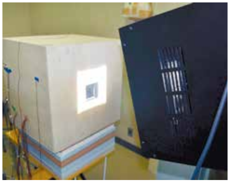
実験は熱負荷測定箱に人工太陽装置で平行光を照射して行う
