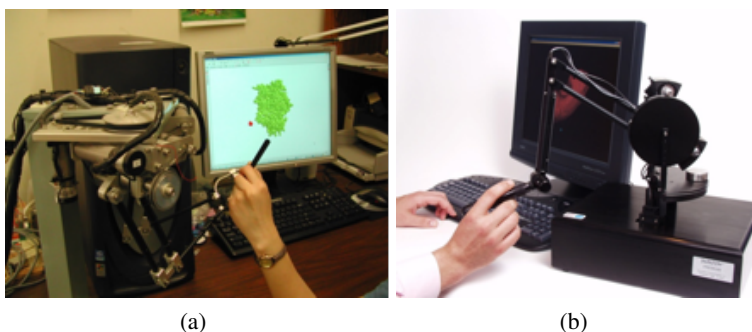
Figure 12. (a) Interface utilisateur avec le dispositif haptique de CAMD (b) Le dispositif haptique PHANTOM pour l'application HAMStER
