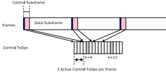
Fig. 1. S-TDMA Framing
