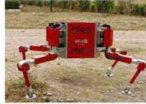
(d) Four-legged walking machine SILO4 (67 kg). CSIC, Madrid.
