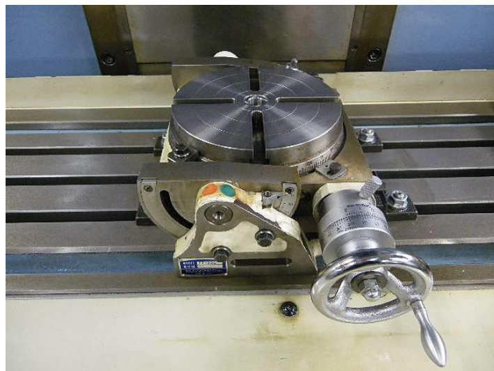
Fig.3.5. Photograph of tilt table (Tudacoma TT-200).
