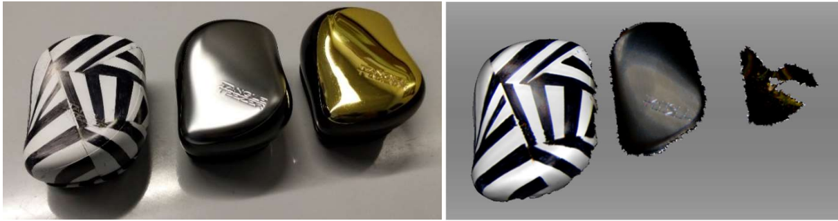
Bild 15: 3D-Scan-Ergebnis in Abhängigkeit vom Glanzgrad
