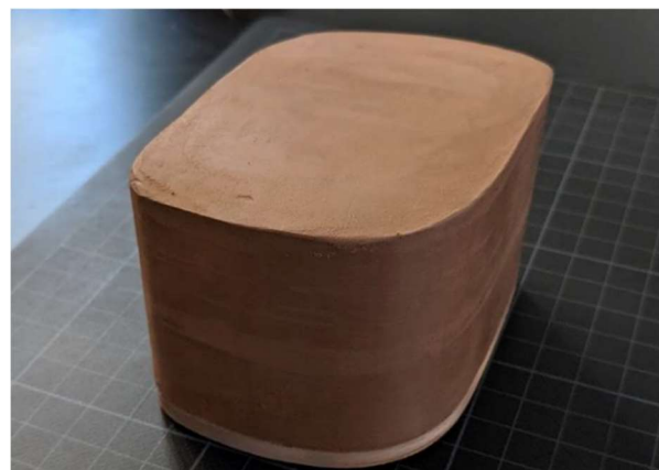
Bild 4 und 5: Grundplatte für Rohling und Clayaufbau mit Übermaß
