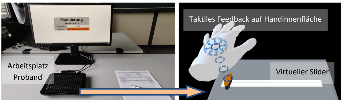
Bild 3: Versuchsaufbau Studie 2 (links), schematische Darstellung des virtuellen Sliders mit Kennzeichnung des taktilen Feedbacks im Raum (rechts)
