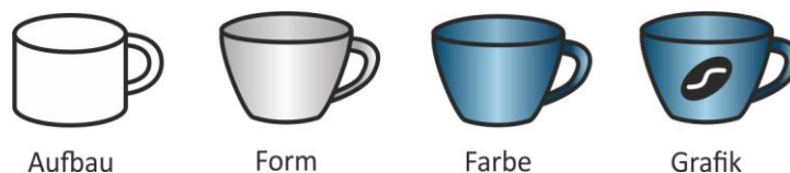
Bild 1: Aufbau, Form, Farbe und Grafik am Beispiel einer Kaffeetasse nach Holder et al. (2019)
