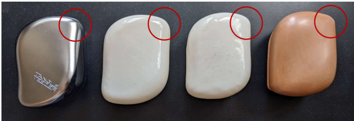
Bild 10: Gegenüberstellung des Originals, des 3D-Scans, des Smartphone-Scans und des Claymodells (v.l.n.r.)
