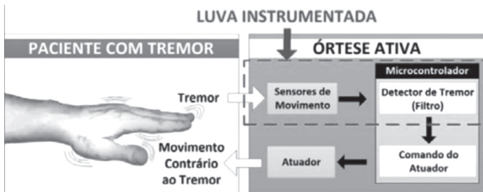
Figura 4: Diagrama esquemático da luva instrumentada e da órtese ativa para caracterização e atenuação do tremor de punho.
