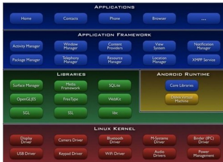
Figura 2.2 Camadas da arquitetura do sistema operacional Android
