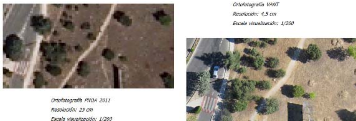
Figura 4. Comparación de resolución entre ortofotografía correspondiente al PNOA 2011 y la realizada mediante UAV.
