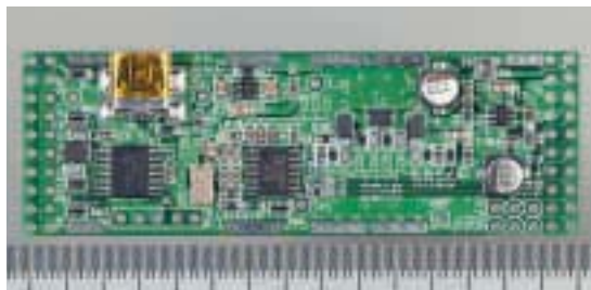
写真 1-1 本書に付属する DDS 周波数シンセサイザ基板
