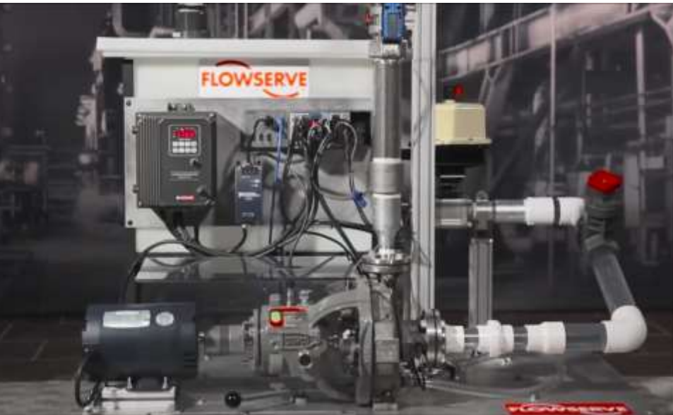
ポンプの予知保全システム
