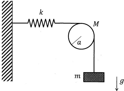
III-22 下図の1自由度の直線振動系において、質量 $m=1[\text{kg}]$ 、ばね定数 $k=100[\text{N/m}]$ とする。この系の臨界減衰定数 $c$ に最も近い値はどれか。
