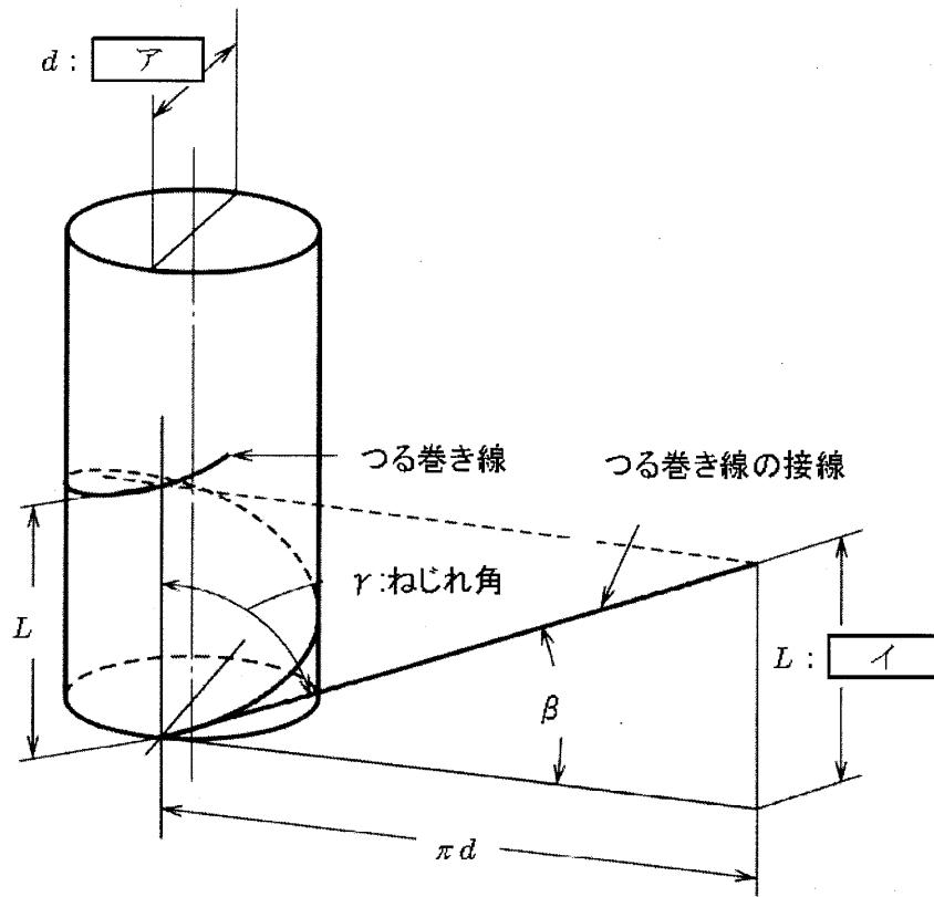
$L$  は、ねじを 1 周回転させたときに軸方向に進む距離であり、図中の記号を使うとウの式で表すことができる。
