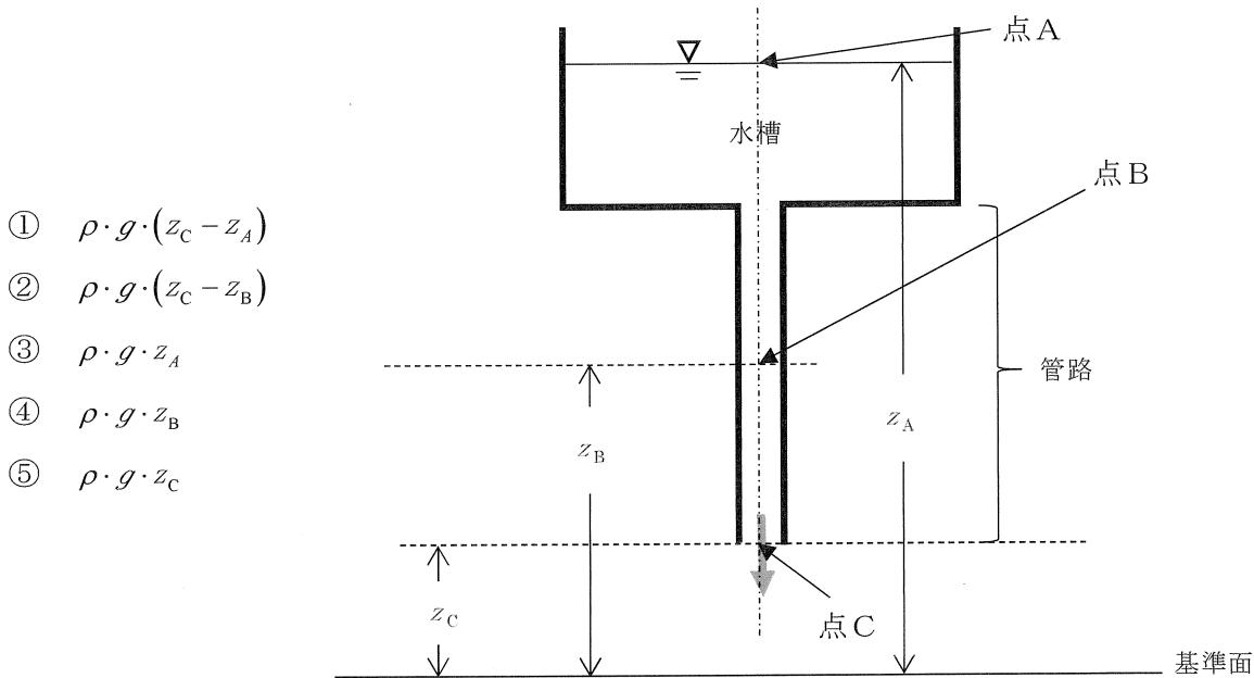
III-18 円形断面の管路流れの損失水頭に関する次の記述のうち、最も不適切なものはどれか。
