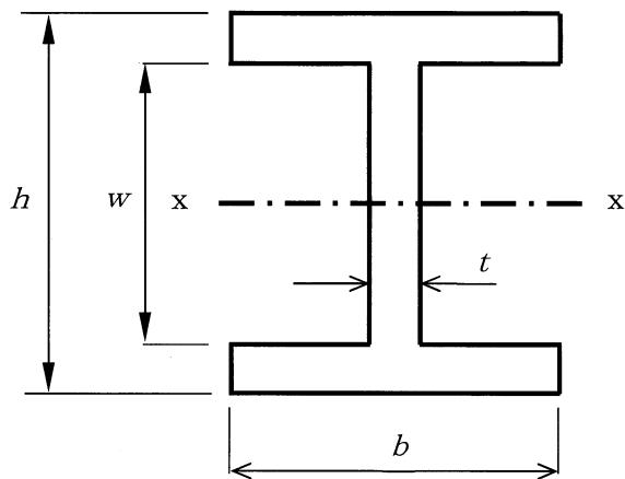
$$\textcircled{1} \quad \frac{bh^3}{12} \quad \textcircled{2} \quad \frac{tw^3}{12} \quad \textcircled{3} \quad bh - (b-t)w \quad \textcircled{4} \quad \frac{(b-t)w^3}{12} \quad \textcircled{5} \quad \frac{bh^3 - (b-t)w^3}{12}$$
