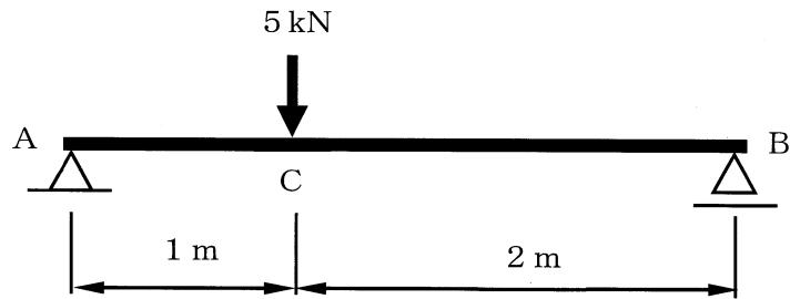
$$R_A \text{ [kN]} \quad R_B \text{ [kN]} \quad M_C \text{ [kN} \cdot \text{m}]$$
