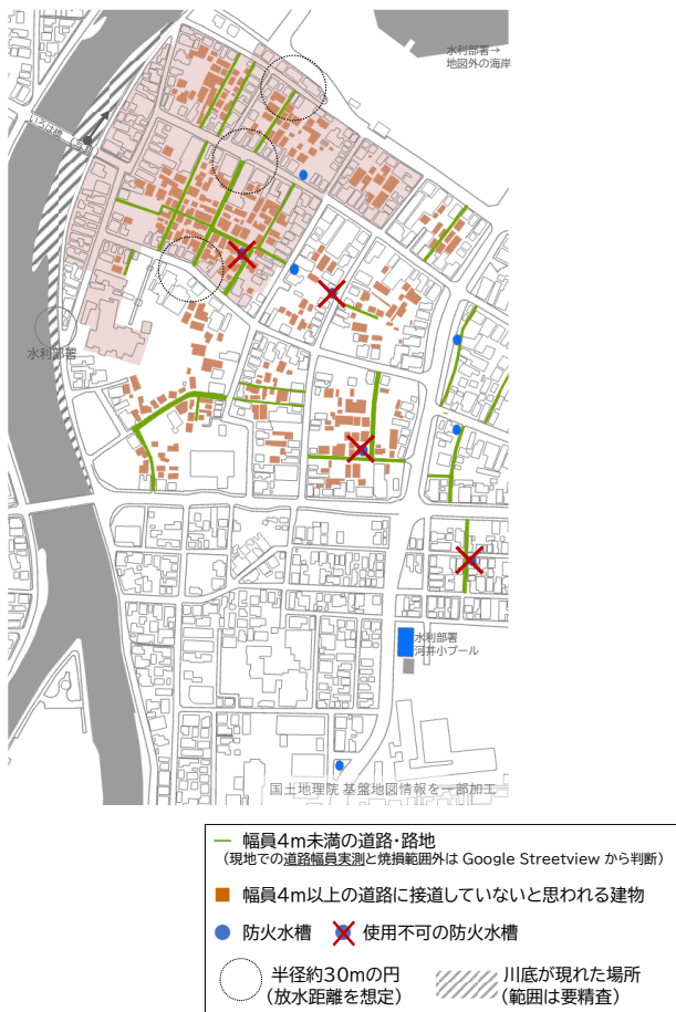
図5 輪島市大規模火災の焼失範囲及びその周辺の市街地の状況と防火水槽
