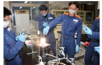
化学火災鑑識要領 (テルミット反応の実験状況)
