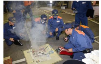
微小火源鑑識要領 (ガラス製灰皿内の温度測定)
