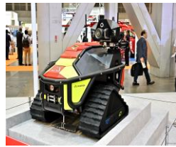
【無人走行放水ロボット】
