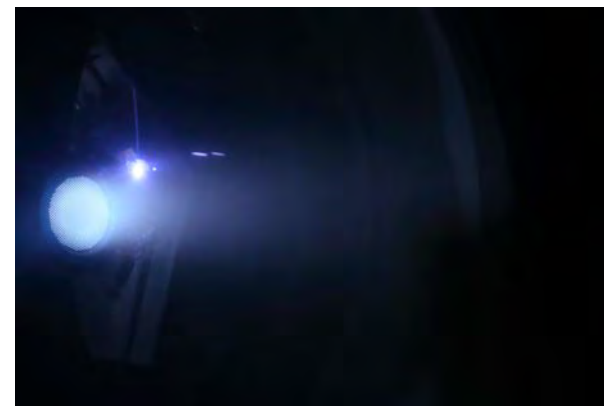
フライトモデルの真空チェンバ内での噴射試験の様子
