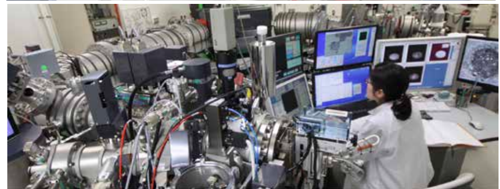
元素分布・同位体分布を観察する同位体顕微鏡(©北大)
