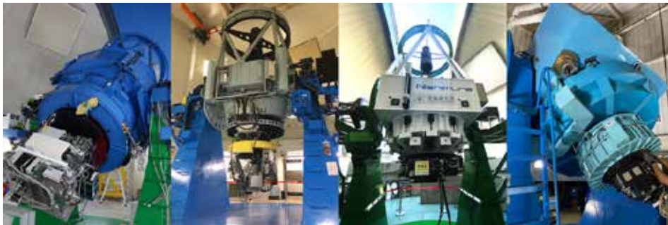
図4-1 本観測で使用した望遠鏡および装置(画像クレジットは()内の各大学) 左からかなた望遠鏡+可視赤外線同時カメラHONIR(広島大学)、なゆた望遠鏡+広視野グリズム分光撮像装置WFGS2(兵庫県立大学)、ピリカ望遠鏡+可視マルチスペクトル撮像装置MSI(北海道大学)、普賢山天文台1.8m望遠鏡+3色撮像装置TRIPOL#3(ソウル大学)
