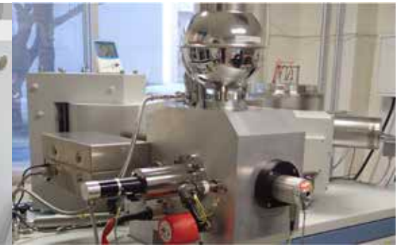
同位体分析・年代分析を行う精密質量分析装置(©東工大)
