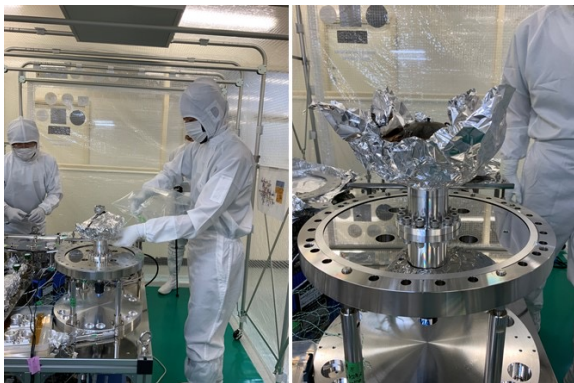
12/6 19:20 ガス採取装置の接続作業
