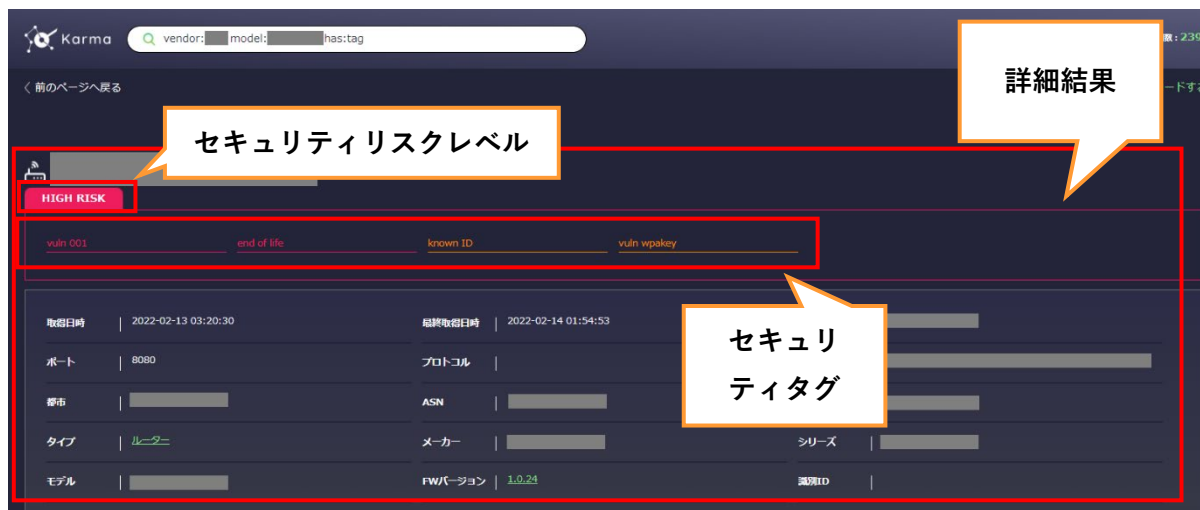
図 5-4 セキュリティタグを持つ IoT 機器検索の詳細結果画面
