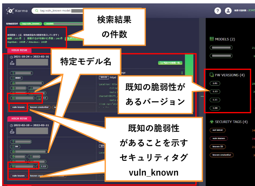
図 5-12 脆弱性に基づくセキュリティタグを持つ IoT 機器の検索結果画面
