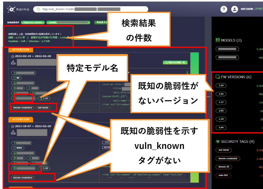
図 5-13 脆弱性に基づくセキュリティタグを持たない IoT 機器の検索結果画面
