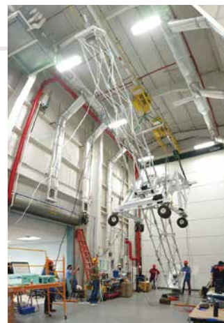
持ち上げ試験中の様子。総重量約2tのXL-Calibur本体が吊り上げられ、45°の傾きで望遠鏡が空を向くよう保つ姿勢制御が行われています。望遠鏡と偏光計の相対位置確認の試験も同時に行われました。
