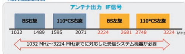
■図3. 新4K8K衛星放送の受信システムで利用する周波数帯
