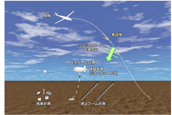
全機ロバスト低ブーム設計技術飛行実証試験イメージ
