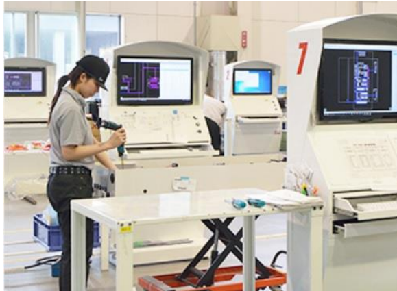
図11 配線作業手順のモニター表示事例(出典:アイデン)
