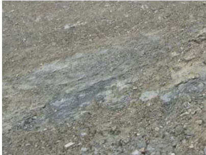
写真 2-4 C 部の拡大 (頁岩の風化)
