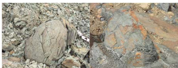
写真 5—1 玉葱状に風化した泥岩と板状に風化した頁岩
