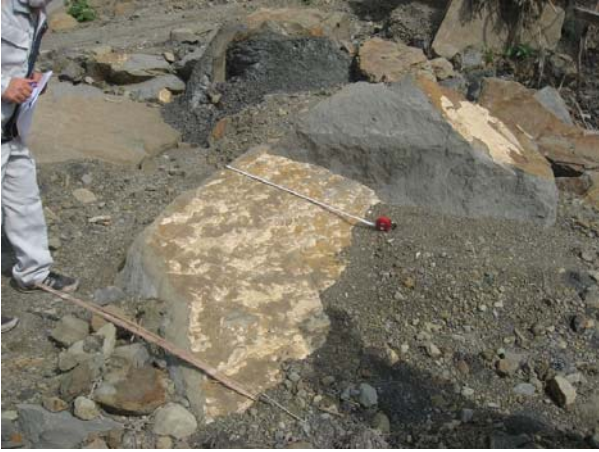
写真2-16 泥岩に付着した方解石
