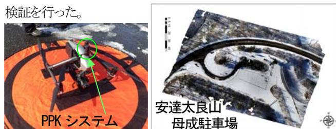
図-2. PPKを搭載したUAVと解析対象(駐車場)
