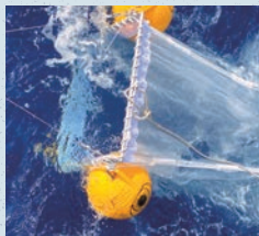
海の表面に浮かぶマイクロプラスチックを回収するため、「ニューストネット」と呼ばれる網を船に取り付ける。
