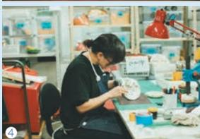
①各地から集まった海洋プラを粉碎し、採取地・色別に保管。②熱で溶かしてプレス機で成形。③原材料には多種多様なプラスチックが混在。融点や収縮率の違いが模様を描く。④縁をカッターでそいで仕上げる。海洋プラを分別せずに成形する製造技術は特許を取得している。
