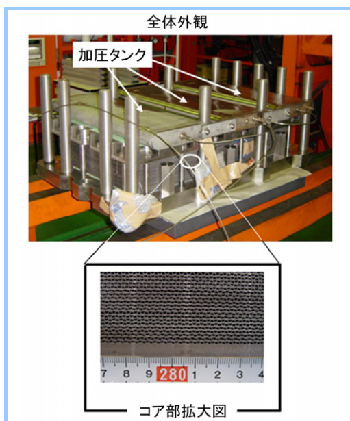
図4 プレートフィン型熱交換器の試作モデル
