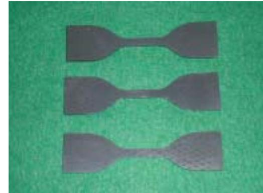
引張試験用試験片 ダンベル状 3号形
