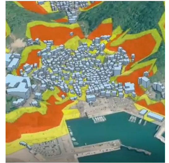
土砂災害リスクの可視化 建物LOD1と土砂災害警戒区域を重ねて可視化。
