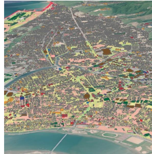
津波浸水リスクの可視化 建物LOD1 (用途別) と南海トラフ浸水想定を重ねて可視化。
