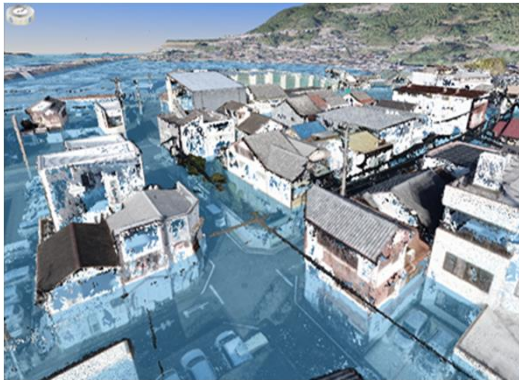
建物モデルにsfm点群データを重畳したものに洪水浸水データを重ね合わせ可視化したもの
