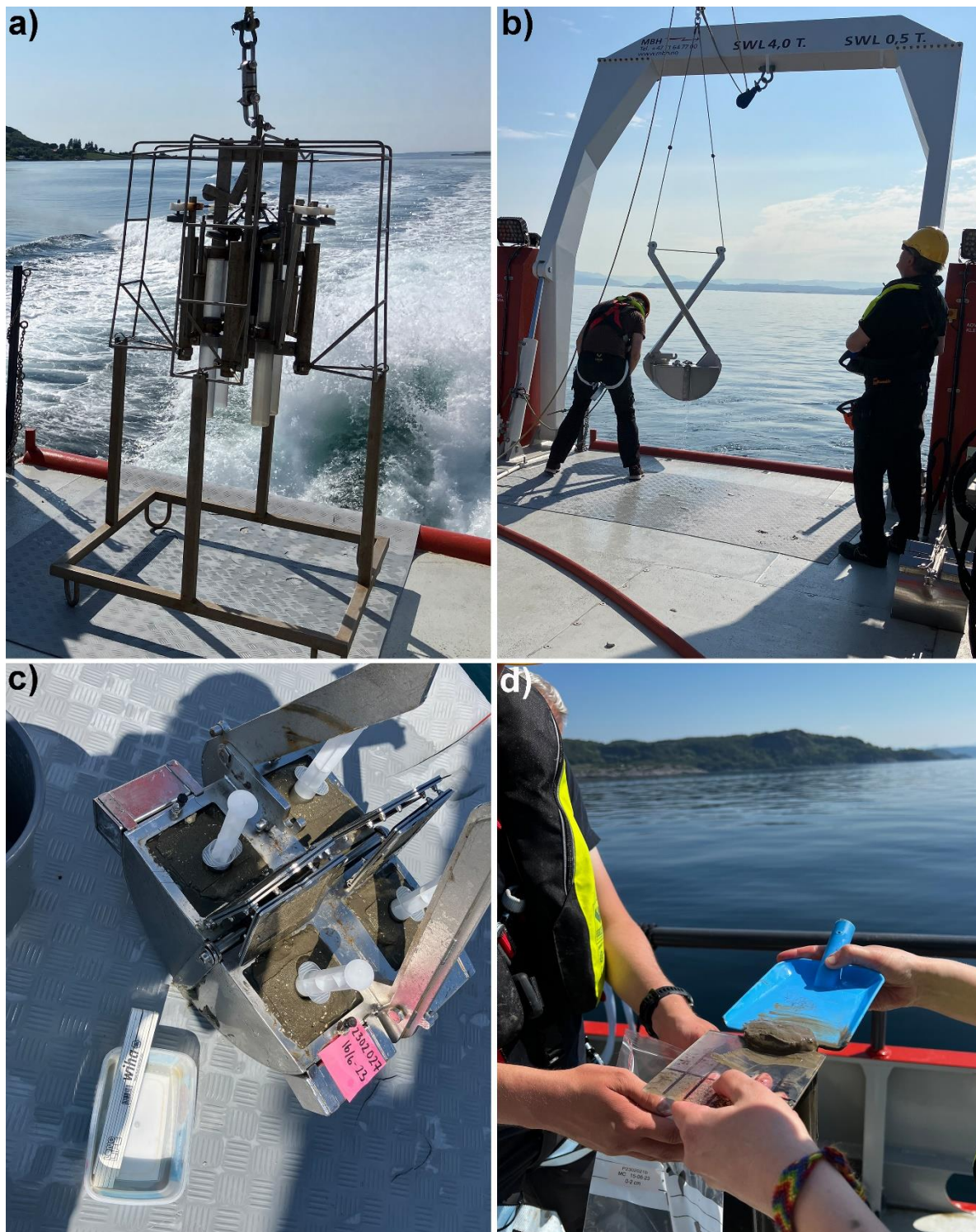
Figur 2. Prøvetaking. a) NGUs multicorer. b) Van Veen-grabb. c) Grabb med fire sprøyteprøver hver ti centimeter lange. d) En sedimentkjerne fra multicorer skives med plastspatler.
