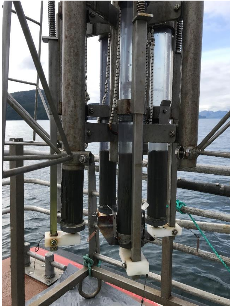
Figur 2. Prøvetaking med multicorer, som tar opptil fire kjerper per stasjon. Lukkemekanismen utløses idet prøvetakeren treffer bunnen, og stenger topp og bunn av hvert rør. For hver stasjon er de øverste 2 cm av én kjerne brukt til analyser av sedimentenes kornfordeling og metallsammensetning, og de øverste 2 cm fra to kjerper brukt til analyse av organiske miljøgifter.
