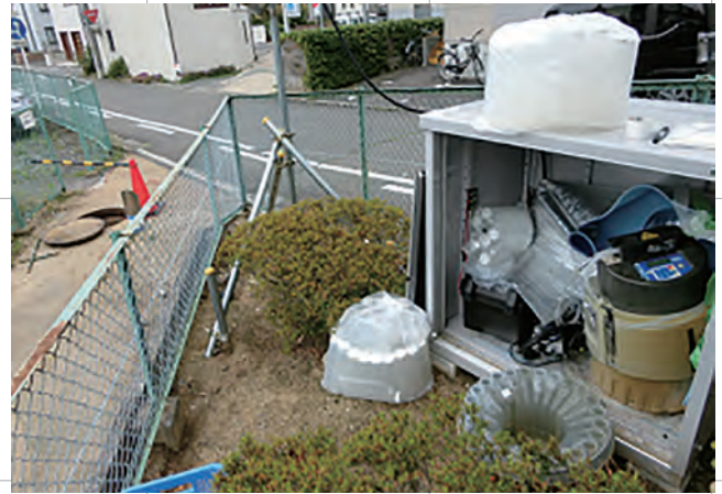
図1 下水試料採取地点の様子。右は自動採水装置と採取された試料。左奥が調査対象の下水道で採水管が接続されている。
