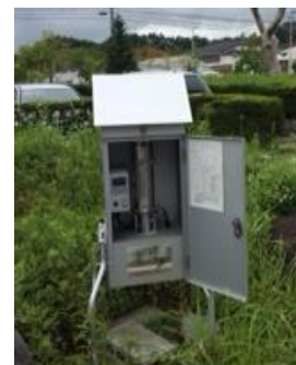
写真 空気を捕集する「ハイポリウムエアサンプラー」という装置
