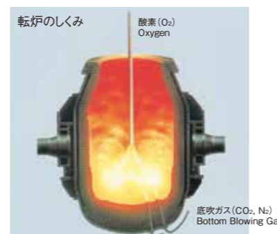
転炉の炉内模式図 Schematic View of Converter
