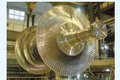
タービンブレード【最終段42インチ長翼】 Turbine blade (42 inches long at the last row)
