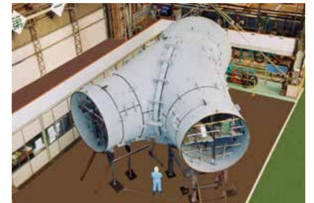
ペンストック Penstock
