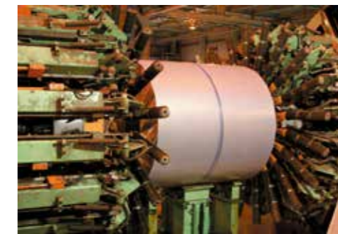
全自動コイル梱包 New Automatic Coil Packing Line
