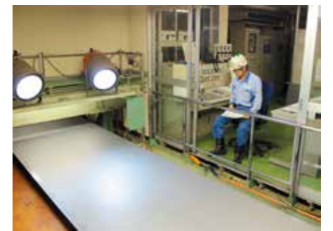
分割ラインの検査室 Recoiling Line Inspection Room
