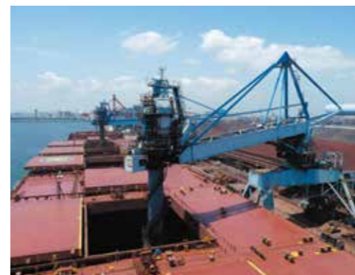
連続式アンローダーによる原料荷揚げ Unloading Raw Materials by Continuous Unloader
