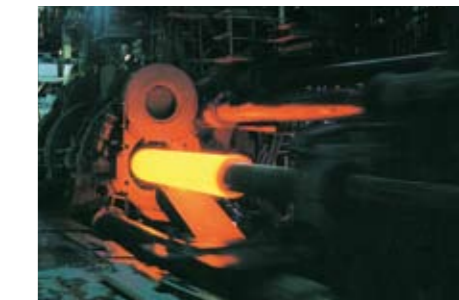
熱間押し製管機 Horizontal push bench
