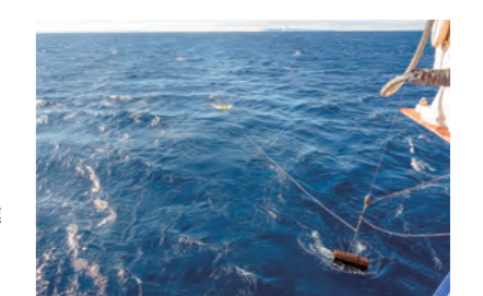
「しらせ」船上における係留システムの設置・回収。南 大洋の海洋物理観測の一環として、1990年代以降 精力的に実施し、近年の南極底層水形成やポリニヤ 域の海洋環境の理解に貢献している
