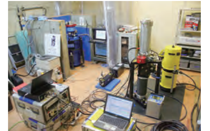
昭和基地重力計室での超伝導重力計、絶対重力計(FG-5, A10)による重力の並行観測
