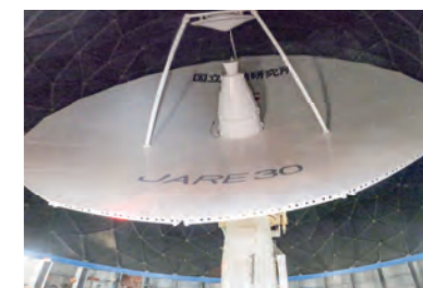
各種衛星データ受信のために導入された多目的大型アンテナ
