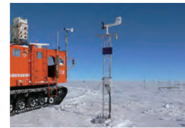
南極内陸高地に設置した衛星通信型無人気象観測装 置(中央)と、積雪構造観測用マイクロ波放射計搭載 の雪上車(左)
