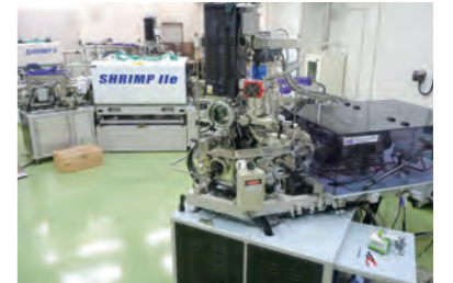
世界に20台しかない大型の二次イオン質量分析計SHRIMP II
