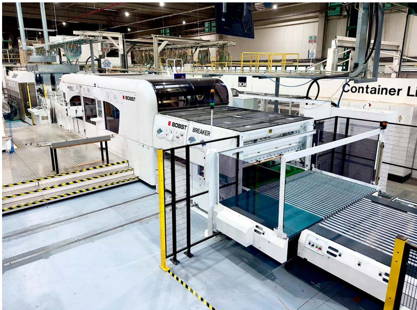
Pohled na výsekovou, výtlupovou a rozlamovací sekci stroje (zleva doprava)
