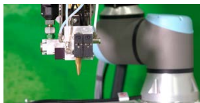
Dávkovací hlava tavného lepidla na rameni robotu
