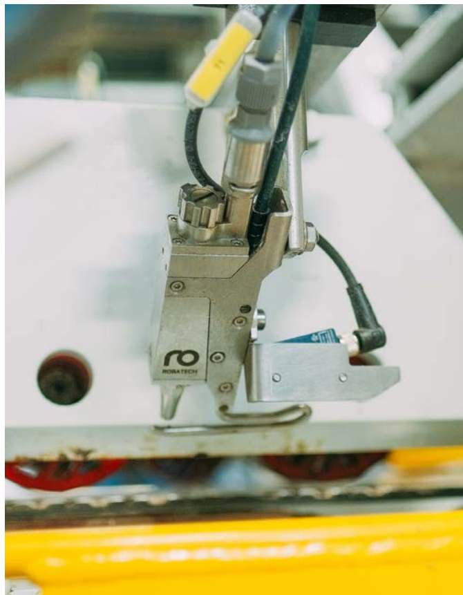
PerfectFold bezkontaktně aplikuje změkčovací kapalinu na dvě linie obalu určené k přeložení.
