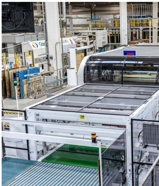
Pohled do rozlamovací sekce stroje (zelená část) a nepoužívanější výsekové nástroje (modrá deska vlevo)
