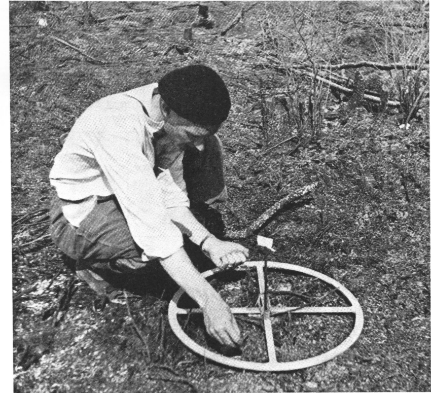
Kuva 6. Kasvillisuushavaintojen paikat ja kylvökohteet rajoitettiin maahan pysyvästi pantujen rautapuikkojen ja siirrettävän kehikon avulla, jonka keskipisteessä on merkkipuikon vaatima lovi. Kuvassa suoritetaan koekylvöä heti kulotuksen jälkeen. Tyhjä siemenpussi on pistetty rautapuikon päähän merkiksi toimenpiteestä. Tutkimuskohde n:o 1. Ähtäri.
