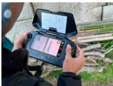
ドローン操作機（点検箇所の画面）
