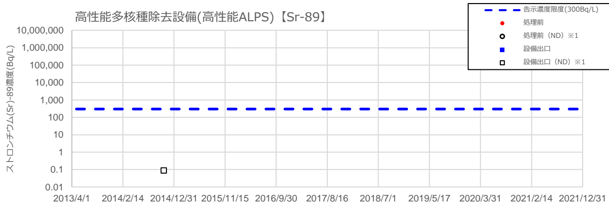
図 II-5-10 各多核種除去設備出入口における放射能濃度 (Sr-89)
