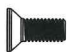
M3 x 8mm Flat Head Screw (2) M3 x 8mm フラットヘッドスクリュー (2)
