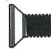
M3 x 6mm Flat Head Screw (5) M3 x 6mm フラットヘッドスクリュー (5)
