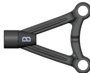
Rear Upper Wishbone B (1) リアアッパーウィッシュボーン B (1)
