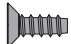
Z576 TP. Flat Head Screw M3x8mm Senkkopfschneidschraube M3x8mm Vis tête tête fraisée M3x8mm T.Pサラネジ M3x8mm
