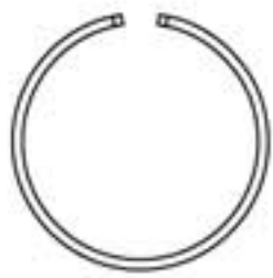
Servo Saver Spring - Gold (2) サーボセイバースプリング-ゴールド (2)
