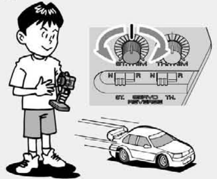
④ ステアリングを使わず走らせてみます。まっすぐに走らない場合はステアリングトリムを使って調節してください。
